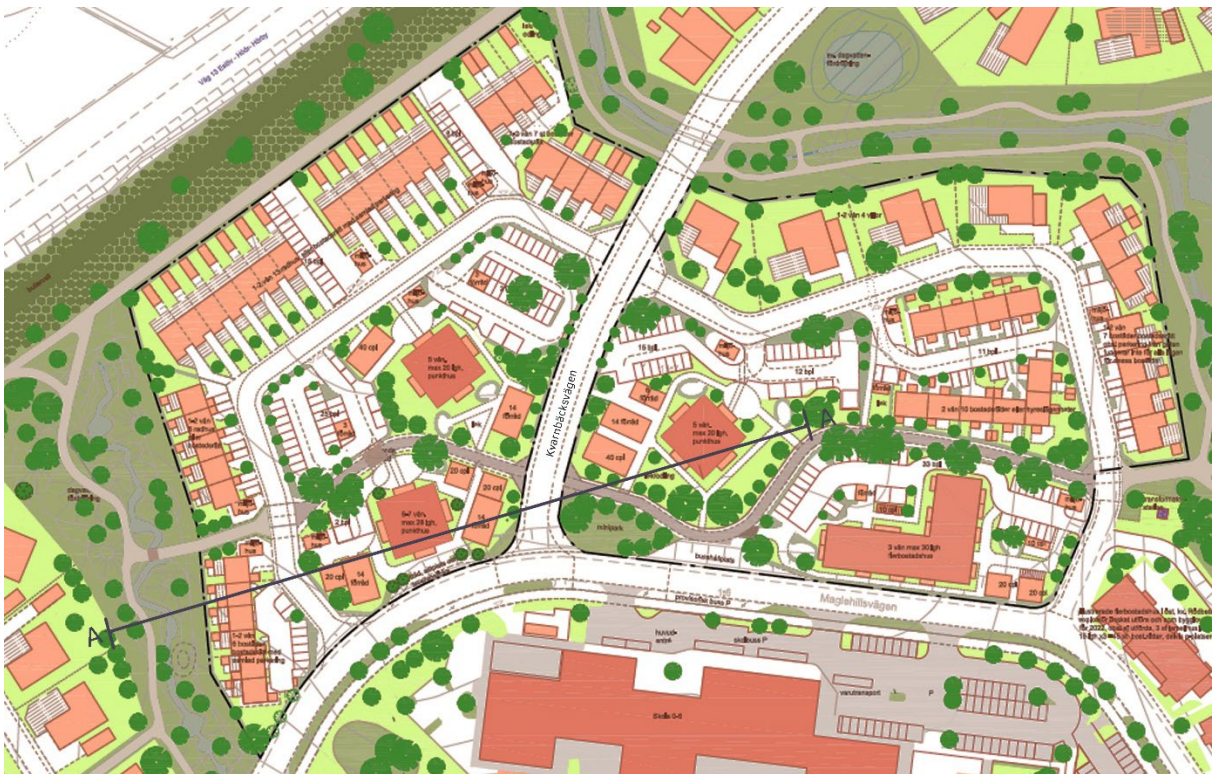
Figur 26. Illustrationen, som visar exempel på utbyggnad, visar sektionens sträckning i figur 22, A-A med punkthusen i 7 och 5 våningar från Maglehillsvägen och från skolan söder om.
