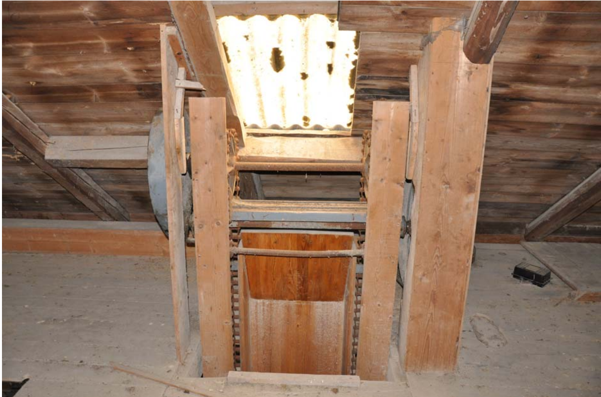
Vindsplan: motordriven hissmekanism för säckhiss.
