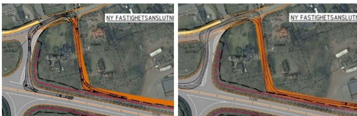
Figur 22. Figurena ovan visar på in (vänstra bilden) och utfart (högra bilden) på Spångahusvägen för lastbilstypen Lspec (specialfordon, framförallt vid byggnation).
