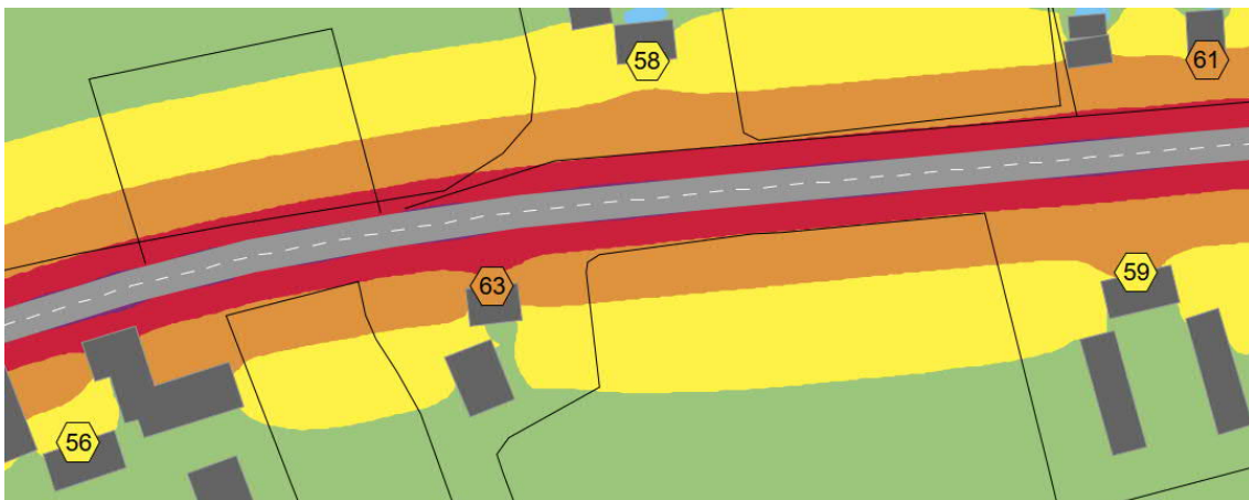
Figur 10. Exempel på beräknade ekvivalenta ljudnivåer vid tillfartsväg (väg 1140), prognos år 2040 med fullt utbyggt planområde (etapp A+B+C).
