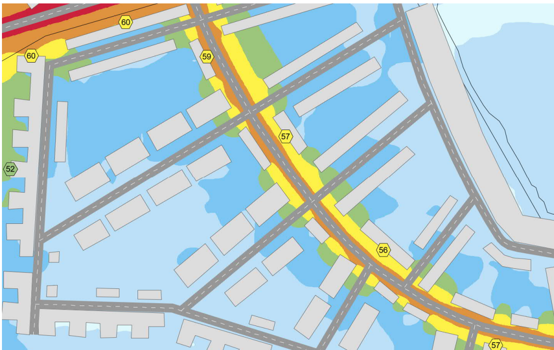
Figur 11. Exempel på beräknade ekvivalenta ljudnivåer vid fullt utbyggt område, etapp A+B+C, prognos år 2040
