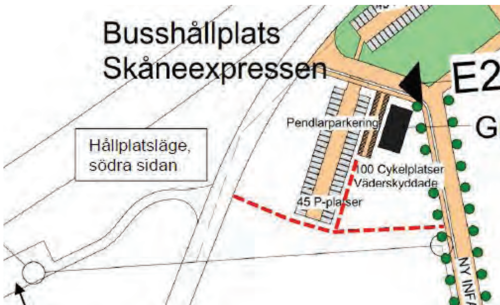
Figur 21. Förslag på den tillkommande pendlarparkeringen för cykel och bil inom programområdet i anslutning till väg 1121. Bilden visar även förslag på en gen gång- och cykelväg till busshållplatsen. Bild från trafikutredningen, figur 15, s 26.
