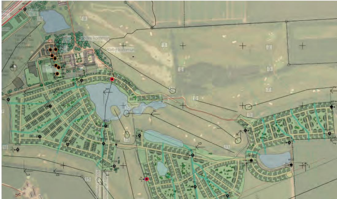
Figur 8. Undersökningspunkternas placering inom området. Punkter med torv markerade med rött, ( MUR), s 94, planritning G-11-1-001, övriga punkter tagna på område för upplag. Upplag av jord- och rivningsmaterial.
