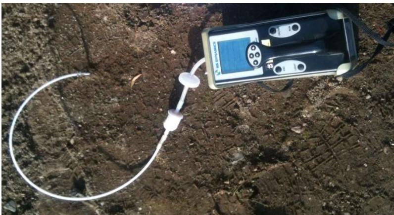
Figur 2. Multigasmätare (av typ Ecoprobe 5 från RS Dynamics)
