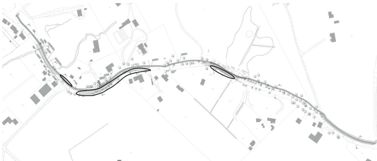
Figur 11. Illustration som visar vilka partier som berörs av att Hörbyvägen breddas söderut.
