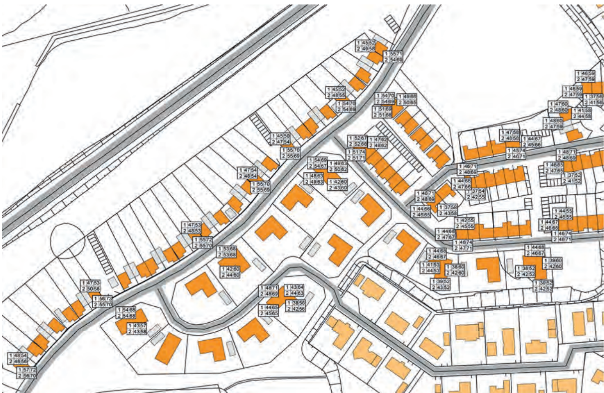
Figur 34. Punktberäkning från trafikbullerutredningen för fasadnivåer med en förlängd bullervall. Förklaring: 1 visar den ekvivalenta och maximala ljudnivån vid fasad på första våningen och 2 visar ekvivalent och maximal nivå vid fasad på andra våningsplanet. Riktvärdet som inte ska överskridas vid fasad är 60.
